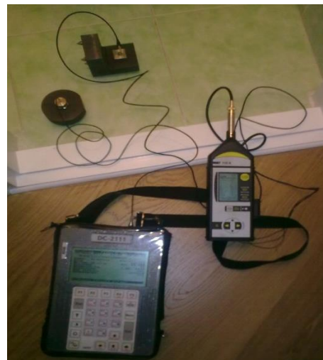
Рис. 4.3. Вимірювання вібрації на підлозі квартири
