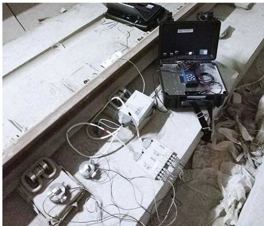
Рис. 4.6. Вимірювання вібрації у тунелі метрополітену
