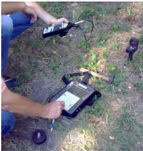
Рис. 4.2. Вимірювання вібрації на поверхні ґрунту
